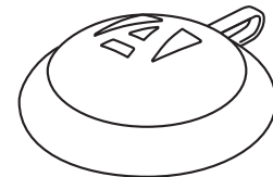
Leszorító korong tömítéssel pontoszerű rögzítéshez, 10 és 16 mm-es lemezvastagsághoz
